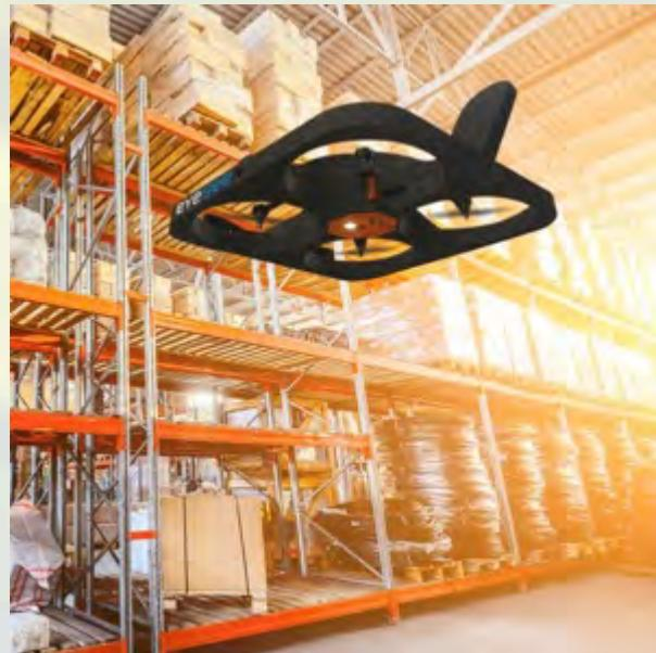
Un drone qui se déplace de manière autonome dans l'entrepôt, pour capturer les informations des codes-barres des palettes et cartons
